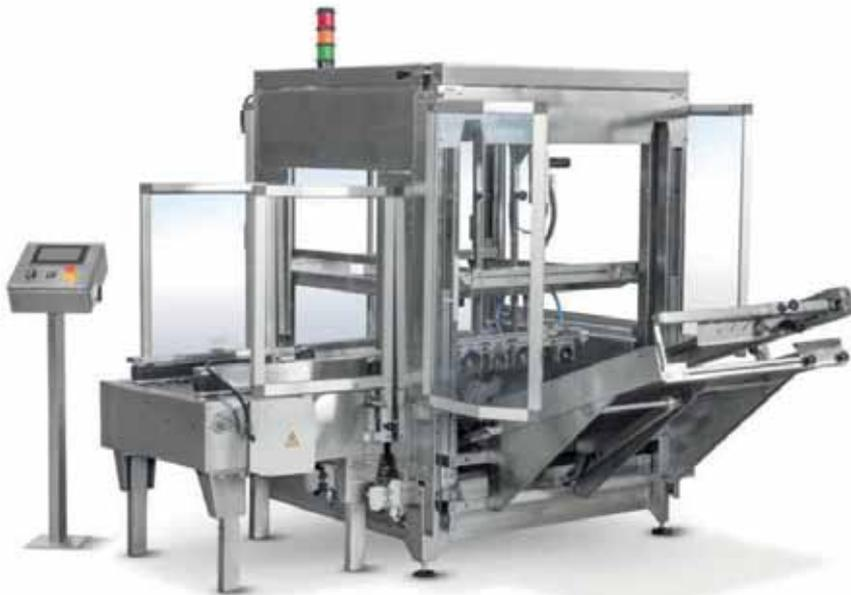
Formano automaticamente le scatole prelevandole dal magazzino laterale ripiegando le quattro falde inferiori. La scatola formata viene nastrata automaticamente e avviata alla linea di riempimento.
